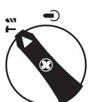
Θέση για **τρύπημα με κρούση**. Σε περίπτωση που όταν θέσετε το ηλεκτρικό εργαλείο σε λειτουργία το εργαλείο δεν αρχίσει αμέσως να γυρίζει, τότε αφήστε το ηλεκτρικό εργαλείο να κινηθεί σιγά-σιγά έως το εργαλείο να αρχίσει κι αυτό να γυρίζει.
