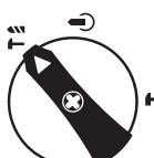
Pozíció ütvefűráshoz. Ha a fűrőszerszám nem forog el azonnal a bekapcsoláskor, hagyja a gépet lassan járni, amíg a fűrőszerszám el nem forog.
