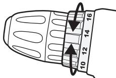
**Nota: la selezione di una coppia più alta permetterà al trapano di usare una maggiore coppia per avvitare o svitare la vite. Per evitare danni alla testa della vite, si consiglia di iniziare selezionando una coppia più bassa e aumentare quando necessario.**
