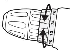
на завинтване, когато използвате накрайник за отвертка. Това ще помогне да се избегне повреда на обработвания детайл и/или винт.
