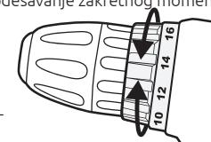
**vijka. Da biste sprječili oštećenje glave vijka, preporučuje se da uređaj prvo podesite na manji zakretni moment te da ga povećavate po potrebi.**
