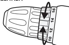
**Figyelem:** A magasabb forgatónyomaték-beállítás növeli a csavarbejtás/-kicsavarozás forgatónyomatékát. Hogy ne sérüljön a csavarfej, ajánlatos alacsony forgatónyomatékon kezdeni, és szükség esetén növelni.
