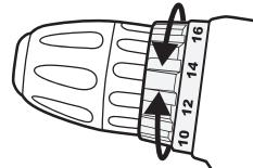
**Napomena:** izbor podešavanja većeg obrtnog momenta omogućuje bušilici da koristi veći obrtni moment za zavrtanje ili odvrtanje zavrtinja. Da biste sprečili oštećenje glave zavrtinja, preporučuje se da prvo podešite manji obrtni moment i da po potrebi povećavate.
