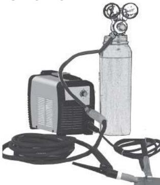
Po otvaranju dovoda za gas pomoću slavine na dršci baklje, regulišite njegov protok pomoću slavine na cilindru za gas (otpriliike 6 litara u minuti).
