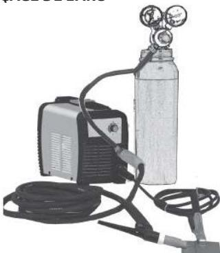
Après avoir ouvert le gaz, utiliser le robinet situé sur la poignée de la torche, en régler le débit avec le robinet situé sur la bouteille (à environ 6 l/min).
