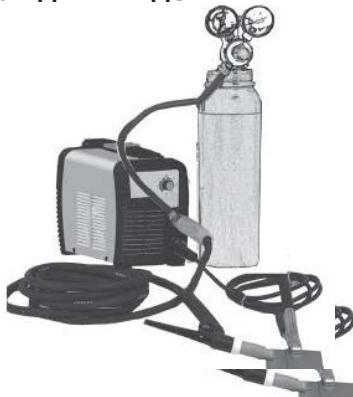
След подаването на газ с помощта на кранчето върху дръжката на заваръчната горелка регулирайте газовия поток с редуктора на газовата бутилка (ок. 6 литра на минута).
