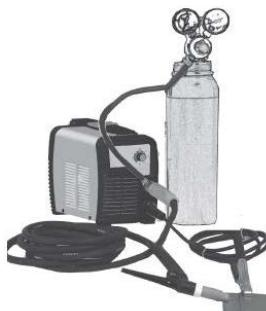
posito rubinetto posto sull'impugnatura della torcia, regolarne la portata tramite il rubinetto-posto sulla bombola (intorno ai 6 litri/min).
