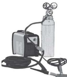
Μετά το άνοιγμα της παροχής αερίου ρυθμίστε τη ροή του μέσω της βαλβίδας στη φιάλη αερίου (ηερ. 6 λίτρα ανά λεπτό), χρησιμοποιώντας τη βαλβίδα στην λαβή του σωλήνα.
